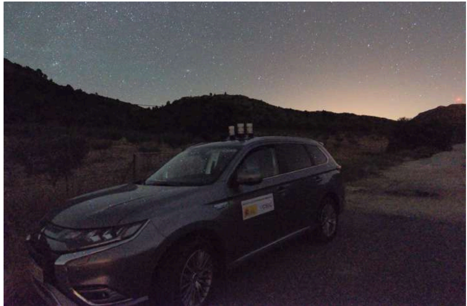
Unidad móvil para la toma de datos de brillo del cielo. En el techo del vehículo van acoplados los tres dispositivos SQM. Límite oriental del municipio de la Puebla de Don Fadrique. Crédito: Máximo Bustamante Calabria
